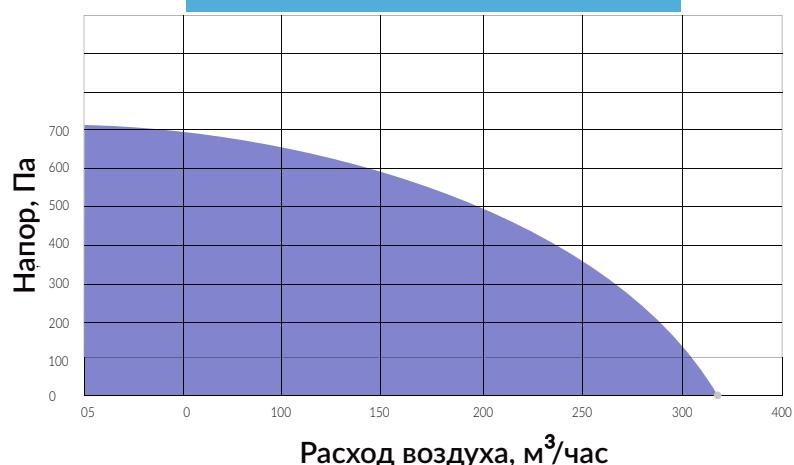
Диапазон работы с фильтром грубой очистки класса G4 + фильтр тонкой очистки HEPA-11 + фотокаталитический фильтр с засыпным кокосовым углём
