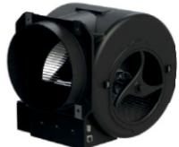
Вентиляторы с энергоэффективными EC двигателями на постоянных магнитах сокращают энергозатраты на передвижение воздуха в среднем на 75% по сравнению с AC двигателями. Кроме того, загнутые вперед лопасти вентилятора обеспечивают стабильность работы и низкий уровень шума. Минимальный уровень шума – 17.2 dB.
