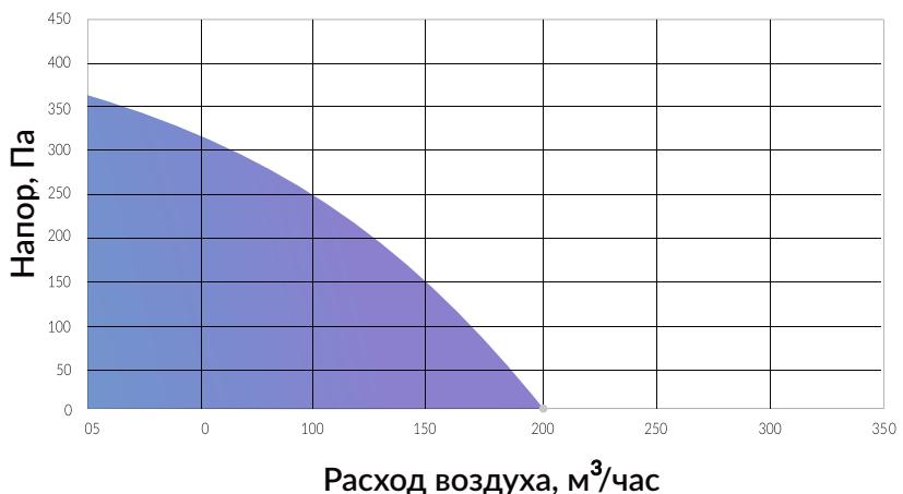
Диапазон работы с фильтром грубой очистки класса G4 + фильтр тонкой очистки HEPA-11 + фотокаталитический фильтр с засыпным кокосовым углём
