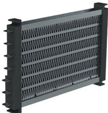
Нагревательные регистры или ребристые нагреватели на основе термисторов с положительным температурным коэффициентом (РТС) применяются для нагрева воздушного потока. Эффект автоматического ограничения температуры, свойственный РТС-термисторам, является гарантией высочайшей эксплуатационной безопасности.
