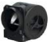
Вентиляторы с энергоэффективными EC двигателями на постоянных магнитах сокращают энергозатраты на передвижение воздуха в среднем на 75% по сравнению с AC двигателями. Кроме того, загнутые вперед лопасти вентилятора обеспечивают стабильность работы и низкий уровень шума. Минимальный уровень шума – 17.2 dB. Класс энергоэффективности вентиляторов IE-4
